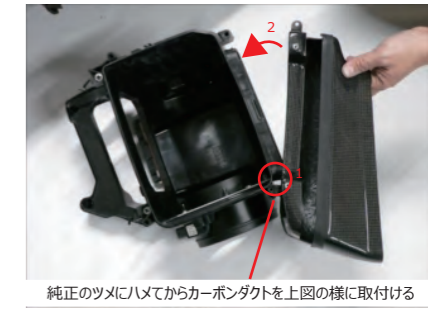
エアボックス下部にカーボンダクトを取付けます。
