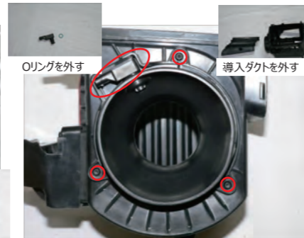
ビスを外してアダプターを取出します。センサーを外します。
