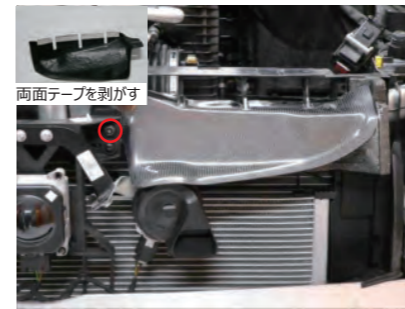
ビスAとM6ナットを使用してカーボンエアガイドを固定します。
