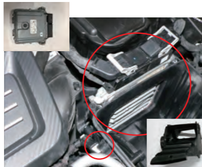
ECUを外します。センサーのカバーを外します。エアボックス下部を導入ダクトごと取出します。
