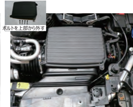
エアボックス上部を取外します。
