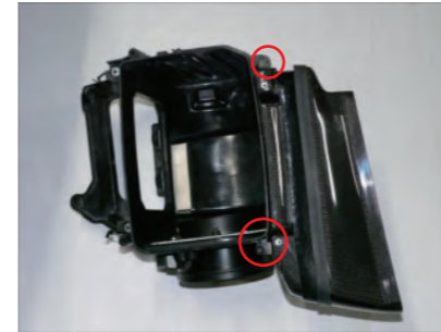
純正ボルトでカーボンダクトを固定します。
