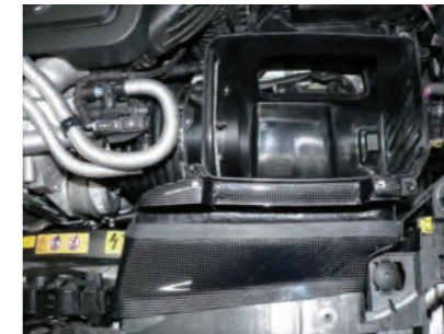
エアボックスASSYを車両に配置します。
