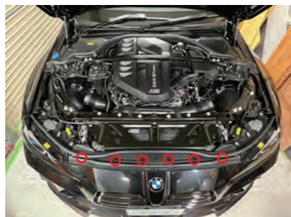
5. クリップ 6 箇所を取外し、樹脂パネルとウェザーストリップを取外します。
