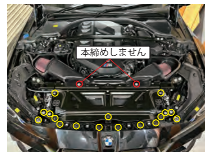
34. 黄色の箇所を本締めします。(赤丸部は本締めしません)
