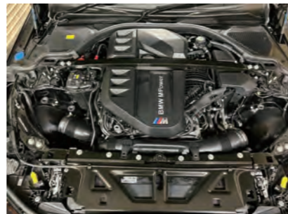
3. 各左右クリーナー BOX を真上に引き抜き、取外します。
