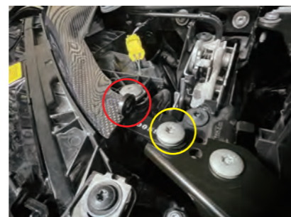
33. ステー A の短い辺の穴にカーボンパネルの凸を差し込みます。純正ボルトでステー A を固定します。反対側も同様に固定します。
