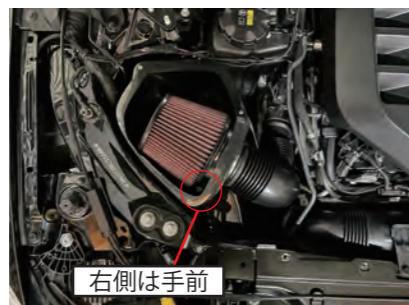
27. バンドの六角部が左右で取付位置が異なりますので写真を参考に取付けて下さい。(フィルターメンテナンス時にドライバーで緩められるようにするため)
