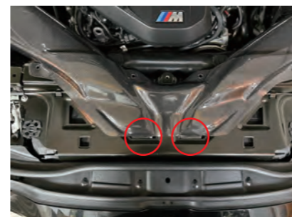
41. 純正のパネルにカーボンパネルを取付けます。取付ける際にカーボンパネルの爪を引掛ける様にします。
