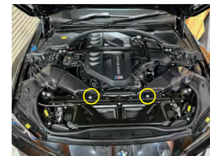
40. 導入ダクトの位置を確認して純正ボルトを本締めします。
