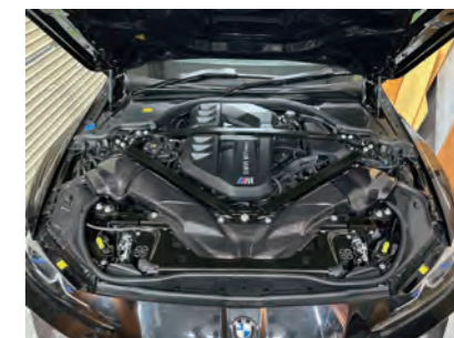
43. タワーバーを戻し、作業終了です。
