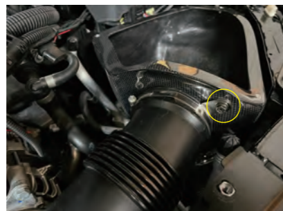
24. ステー B をボルト A x1 でカーボンケースに固定します。
