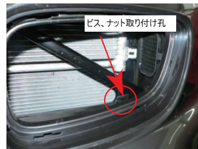
グリル内のサポートバーに導入ダクトを取り付けます。導入ダクト裏の両面テープを剥がし、両面テープとビスAとナットで取り付けます。
