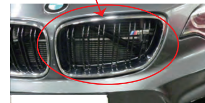
左側グリルを引き抜いて外します。いくつかのツメで留めてあります。マスキングテープでグリル周囲を保護してから作業をお勧めします。
