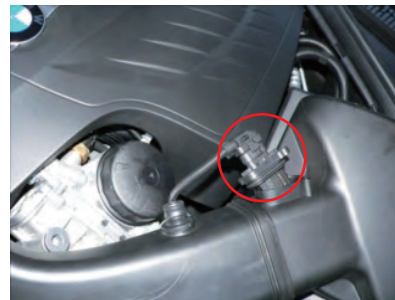
配線カプラーは外さずにエアマスセンサーのビス2か所を外し、センサーを外します。エアクリーナーケースASSYを外します。
