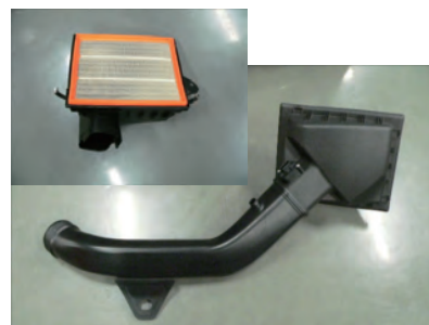
サクショパイプ一体型のケース上部を外し、次に下側のケースを外します。
