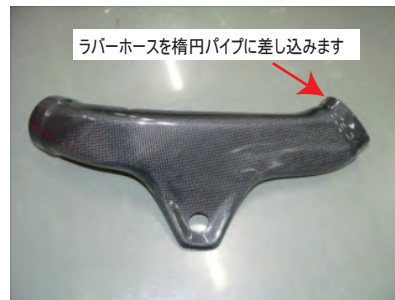
カーボンサクショパイプをノーマルのインタークホースに差し込みます。
