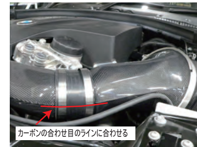
フィルターを挟み、Vクランプで取り付けます。向きを微調整しながらフィルターとケースを挟み、Vクランプで取り付けます。
