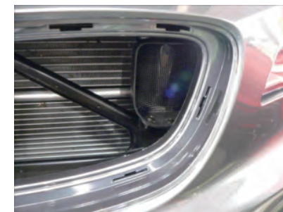
取り付け図 純正エアガイドに空気を導くように配置します。
