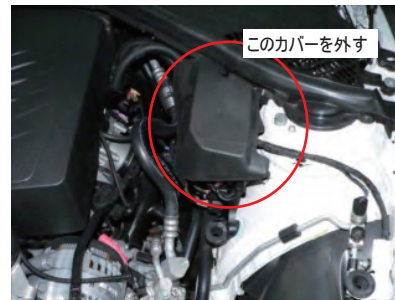
配線ケーブルのカバーを一度外します。
