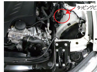
矢印部のカーボンケース固定位置のタッピングビスを外します。
