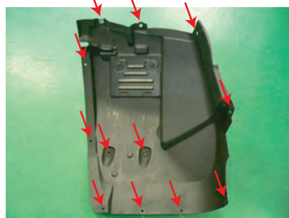
ノーマルのバンパー部エアダクトを外します。左タイヤを外し、インナーフェンダーを取り外します。(矢印部はボルト・タッピング固定位置)
