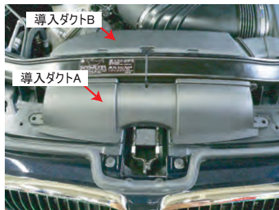
ノーマルの導入ダクトA、Bを取り外します。
