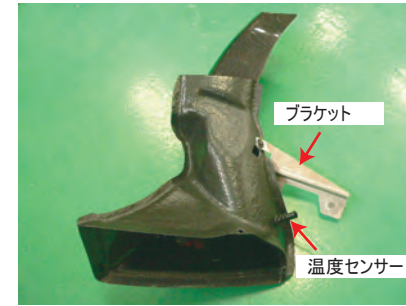
ノーマルエアダクトから、固定用ブラケットと温度センサーを取り外し、付属のカーボンエアダクトに取り付けます。(ビスA使用)
