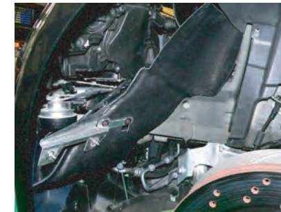
ノーマルと同じようにカーボンエアダクトを取り付けます。温度センサーのカプラーも元の通りに接続します。
