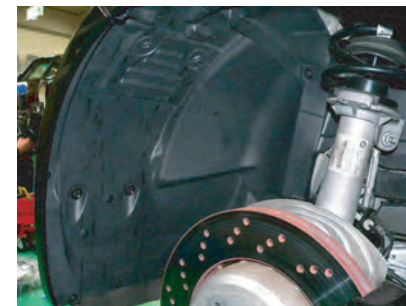
バンパー及びインナーフェンダーを元に戻し、タイヤを取り付け、車高を降ろします。
