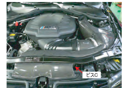
両面テープを剥がし、カーボン導入ダクトAを取り付け、ビスCで固定。最後にボンネットとのクリアランスを確認してください。
