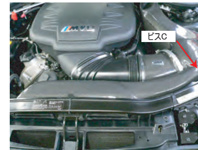
カーボン導入ダクトBを取り付け、ビスCで固定。フィルターケースAはビスBで固定します。同時にVクランプを本締めします。
