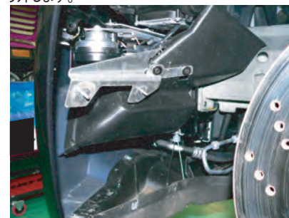
インナーフェンダーを取り外し、次にエアダクトを外します。
