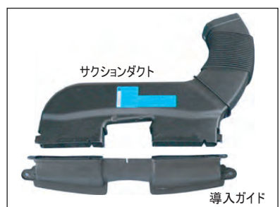
ノーマルの導入ガイド、サクションダクトを外します。インテークホースのバンドを緩めて、上に引き上げて外します。(ラバースタンプ3箇所固定されています)
