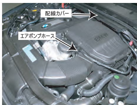
エアポンプホースを矢印のところから一度外します。エンジン上部にある配線カバーもフックを外して、フリーにして作業を行います。
