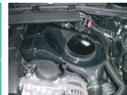
エンジンルームに配置して、インテークホースにそれぞれ挿し込み、バンドで締めます。ラバースタンプの位置を合わせて、挿し込みます。
