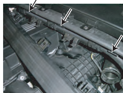
マイナスドライバーでフックを押しながら、引き抜きます。(3箇所)
