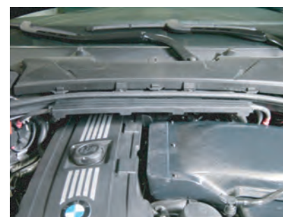
フィルターカバーを取り付け、ビスAで固定します。配線カバーとエアポンプホースを元の通り戻します。
