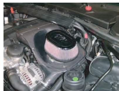
チャンパーボックスにフィルターを取り付け、バンドで締め付けます。
