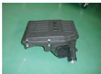
ノーマルの導入ガイド、サクションダクトを外します。インテークホースのバンドを緩めて、上に引き上げて外します。(ラバースタンプ3箇所固定されています)
