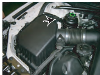
1: クリーナーケース右側はエアポンプホースを外し、左側はウォッシャータンクノズルを外します。
