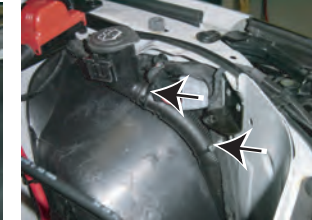
6: ウォッシャータンクノズルをタイラップで固定します。
