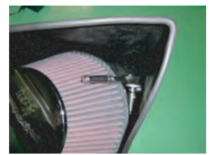
12: フィルターを取り付け、バンドを締めて固定します。逆バング側も同様に組み立てます。
