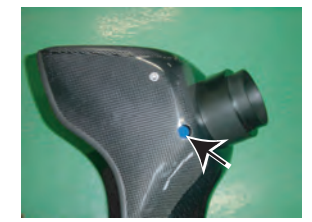
11: グロメットを外し、サービスホールからドライバーを入れてホースバンドを締め付け、固定します。ラバーホースとエアフロは互いに押し付け、フィルターケースと密着させた状態でバンドで締めます。固定後は元の通り、グロメットで塞いでください。
