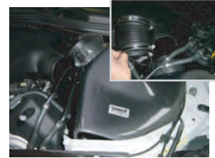
16: 左側はケースASSYを配置して、後からホースを目一杯縮めてパイプとエアフロアダプターを接続させます。
