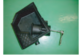
7: ノーマルケースから「整流ハニカム」を取り外します。このファンネルの中にあります。
