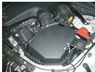
2: エアフロセンサーのカバーを外し、ノーマルクリーナーケースをエアフロセンサーごと取り外します。
