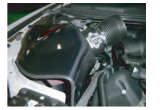
15: 右側はノーマルのホースをエアフロアダプターに取り付け、ケースASSYを斜めから配置し、ホースを目一杯縮めてパイプに差し込みます。
