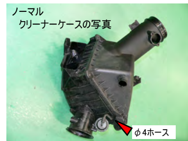
ノーマルクリーナーケース下側を外すとき、φ4ホース(矢印部)を抜きます。
