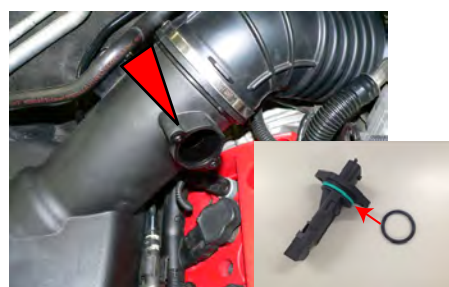
エアフロセンサーを外します。Oリングを付属のOリングに交換します。
