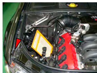
ノーマルクリーナーケース下側を取り出すため、ヘッドライトとバンパーを前にずらします。(矢印部の穴から長いトルクスレンチを差し込む)
