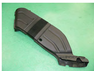
ノーマルクリーナーの導入ダクト
