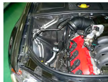
配線、ホースをタイラップで固定した状態。
