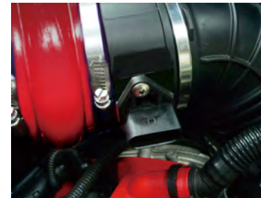
エアフロセンサーを取り付けます。各部、増し締め固定します。
