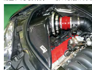
組み付けたアダプターをノーマルサクシジョンホースに取り付けます。ホースを奥に押し込みながらロアケースを下にスライドさせてフィルター、フィルターケースを挟み、Vクランプで留めます。
