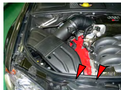
矢印部のビスを外して、ノーマルクリーナーの導入ダクトを外します。
