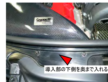
導入部の下側を奥までしっかりと入れます。下側を奥まで入れないと、フィルターケースが正しい位置に収まりません。配置ができた付属のM4ビスで仮留めます。
