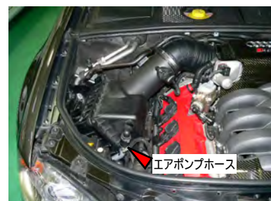
配線やエアポンプホースを外し、クリーナーケース上側を外します。
