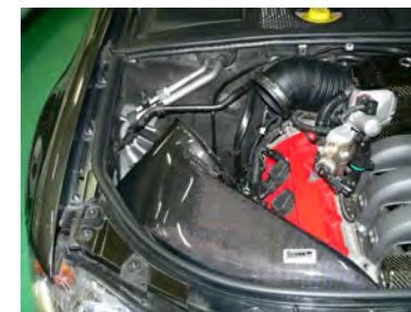
フィルターケースを配置します。予めフィルターケースの中にフィルターを入れておきます。
