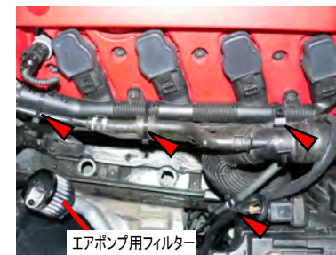
エアポンプのアルミ管に付属のエアポンプ用フィルターを取り付けます。矢印部の配線、ホースをタイラップで留めます。
