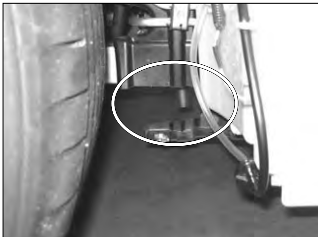
図の○で囲った部分をホース Assy①と干渉しないよう加工する。
